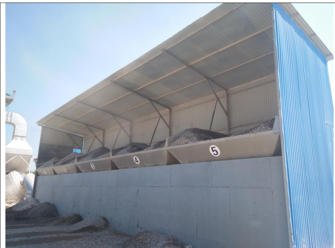
砂石输料斗（采取半封闭）
